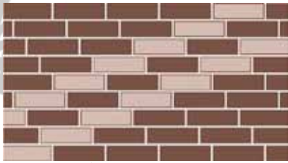
Läuferverband (ein Viertel versetzt schräg)
