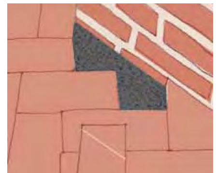
25. Bei schräg verlaufenden Flächen müssen die Ergänzungssteine angepasst und im Anschluss an die Arbeiten eingefügt werden.
